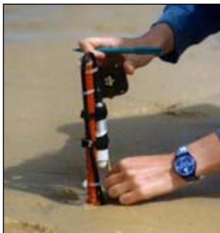
*Figure II.7 Déploiement des capteurs de pression piézoresistifs*
